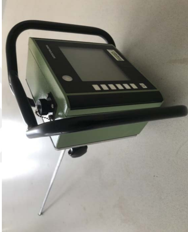
Şekil 2. Arazide penetrasyon direnç ölçümlerinin yapıldığı dijital penetrometre
